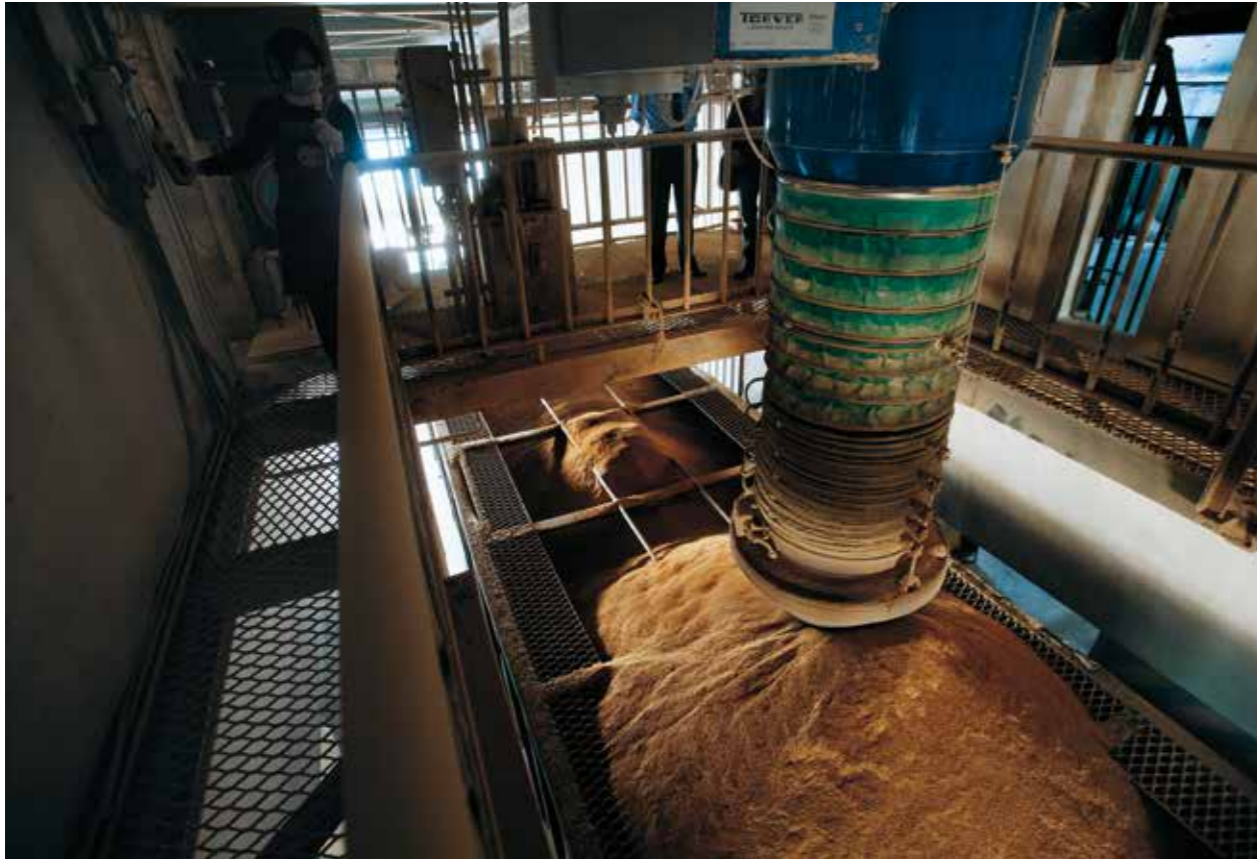
黃豆經溶劑萃取出油脂後，剩下的豆粕經乾燥成為黃豆粉，透過管線直接裝填到散裝卡車上，運往畜牧場。
